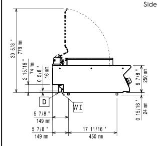
D Drain ΕI Electrical inlet (power) Equipotential screw Water inlet
