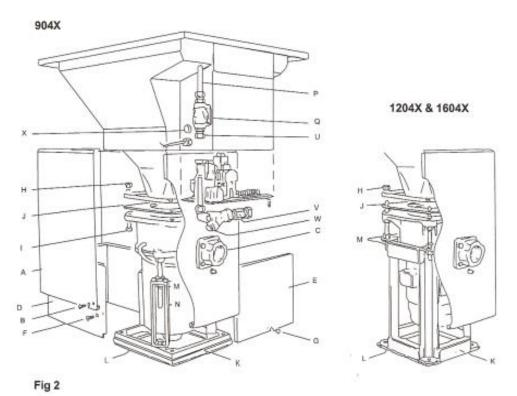
FITTING CONTROL BOX AND SAFETY BAFFLE
