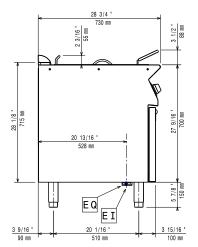
Electrical inlet (power) EQ Equipotential screw
