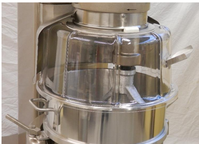
1. Pare-poussière solide fermé et goulotte de versement des ingrédients installée.
