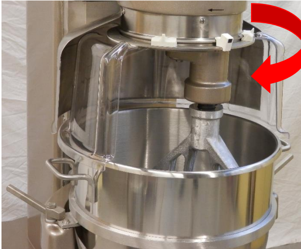
3. Ouvrir la protection en la faisant pivoter dans le sens horaire/vers la gauche.
