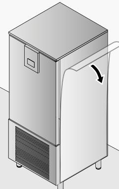
cline nunca el aparato por el lado de la puerta. Para las celdas con el motor a bordo, se aconseja fijar la unidad al suelo, utilizando los soportes suministrados con la unidad.
