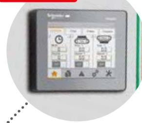
Il Kit Encoder consente di gestire in modo digitale tempi di cottura e temperature di cielo e piano cottura. Il PLC permette di impostare fino a 25 programmi in modo estremamente rapido e preciso, mantenendo costanti i valori di cottura grazie ad un encoder applicato sul motore.
